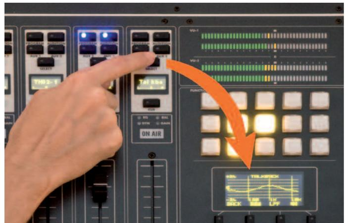
La flexibilidad que ofrece la configuración de AEQ FORUM permite la libre asignación de las señales presentes en el sistema a cualquier canal de control, y la modificación de esa distribución de señales desde la propia superficie.
